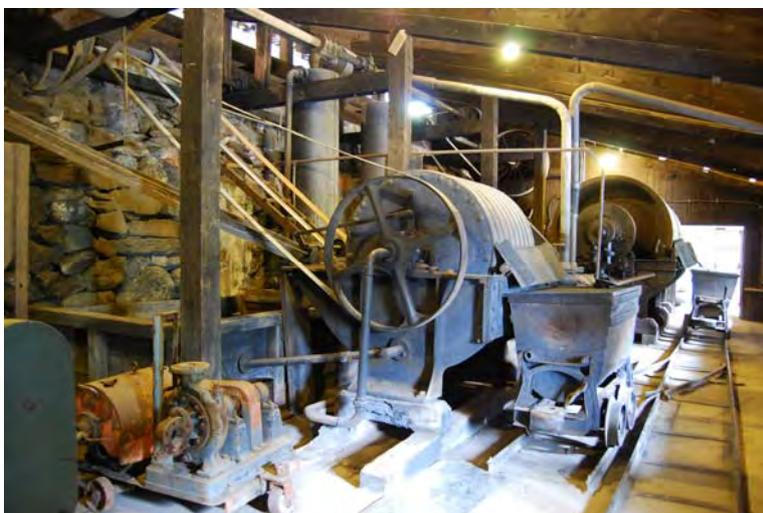
*Die beiden Trommelzellenfilter mit Untertrog zur Entwässerung der Erzkonzentrate*
