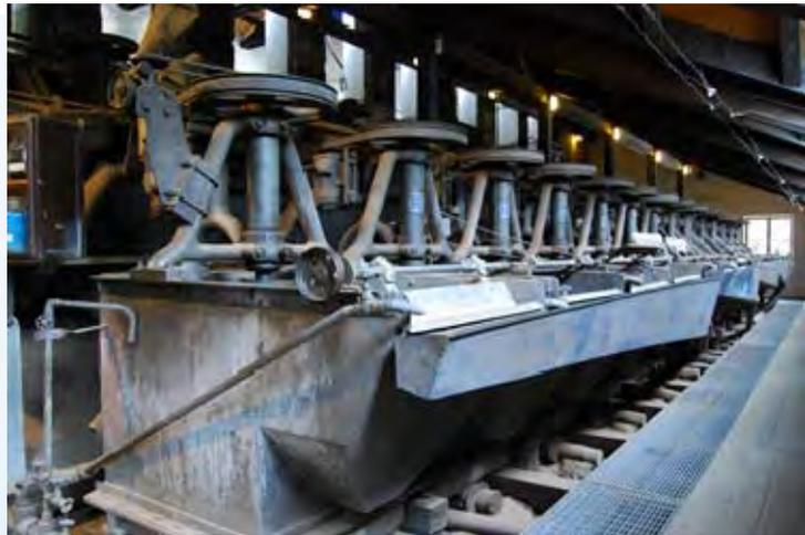
*Zweite Reihe der Flotationszellen in der Aufbereitungsanlage*
