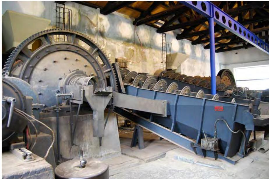
*Erzmühlen (Kugelmühlen/Überlaufmühlen) mit Schraubenklassierer*
