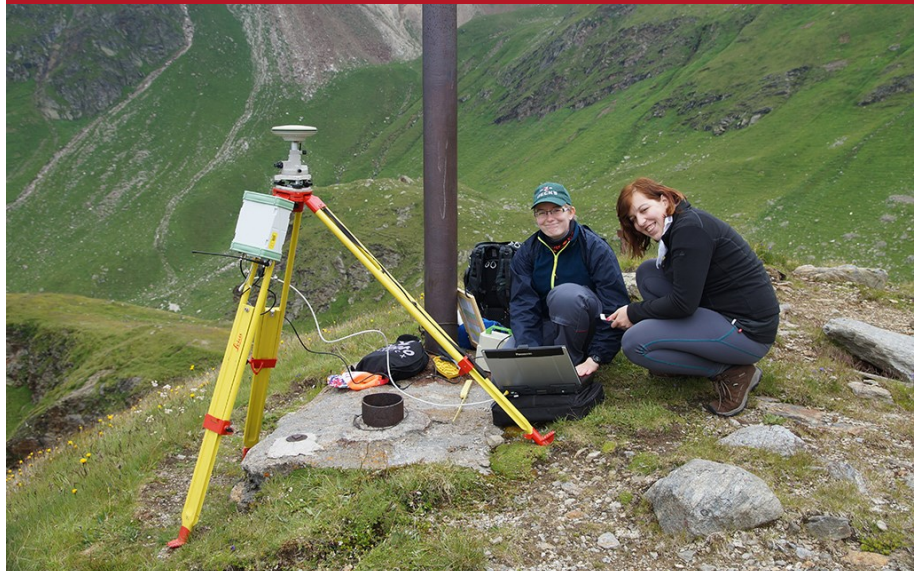
Oben: Studenten im Untertageeinsatz, Unten: Aufbau der GNSS-Basisstation auf einem Referenzpunkt in 2380 m Höhe, © Dr. Thomas Martienßen
