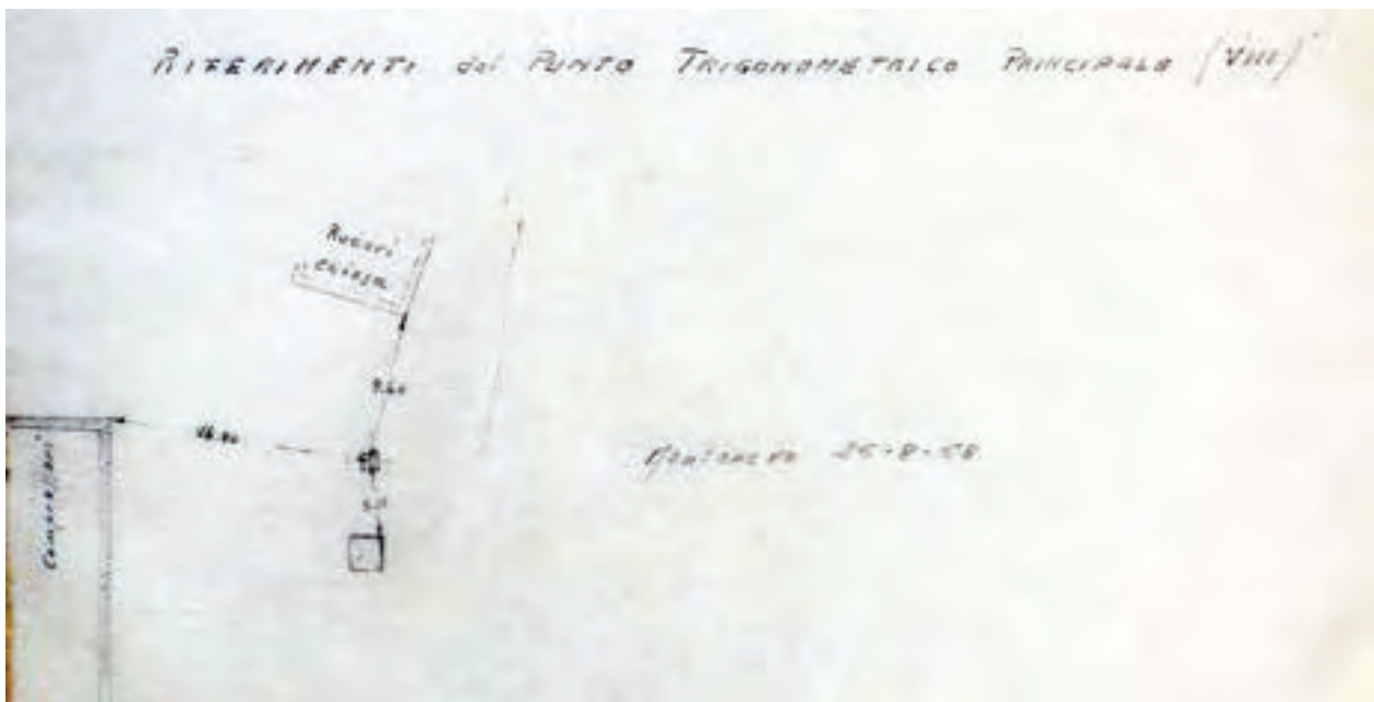
Abbildung 11: Einmessungsskizze des Koordinatennullpunktes (TP 8). In: Miniera di Monteneve, Registro dei rilievi all'interno e all'esterno con Tacheometro 1942, 1943, 1944 (Haupt-Zugbuch), Notiz auf einen Zettel, in das Hauptzugbuch der Jahre 1942-1944 auf die Titelseite geklebt. Schneebergarchiv des Südtiroler Bergbaumuseums, Inv.-Nr. 1095
