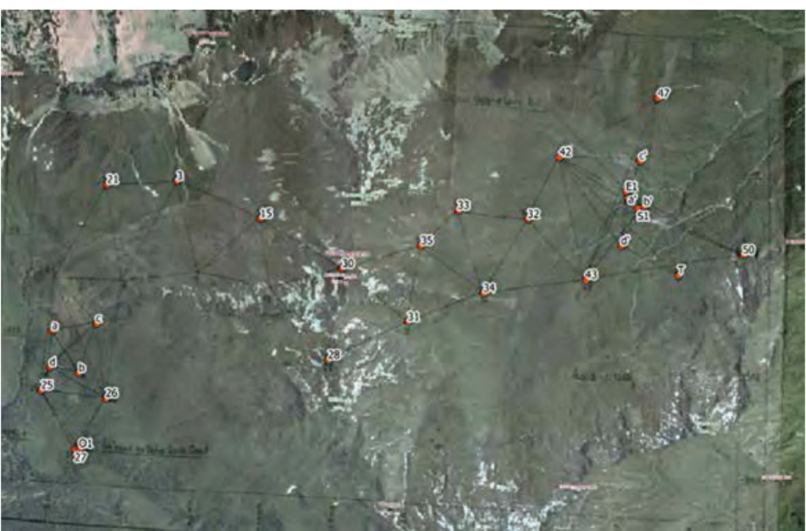
Abbildung 22: Überlagerung des georeferenzierten Dreiecksnetzbildes der Triangulierung von 1942 mit dem amtlichen Luftbild 25
