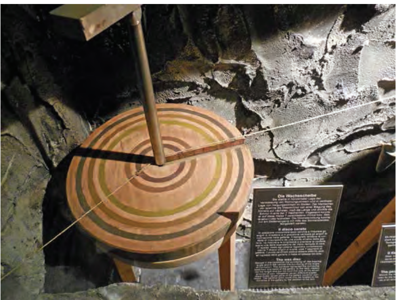
Abbildung 4: Nachbildung eines einfachen Wachskreises mit gespannter Schnur in der Abteilung „Markscheidewesen“ im Südtiroler Bergbaumuseum Ridnaun. Foto: Marcus Wandinger, 6. Juli 2014
