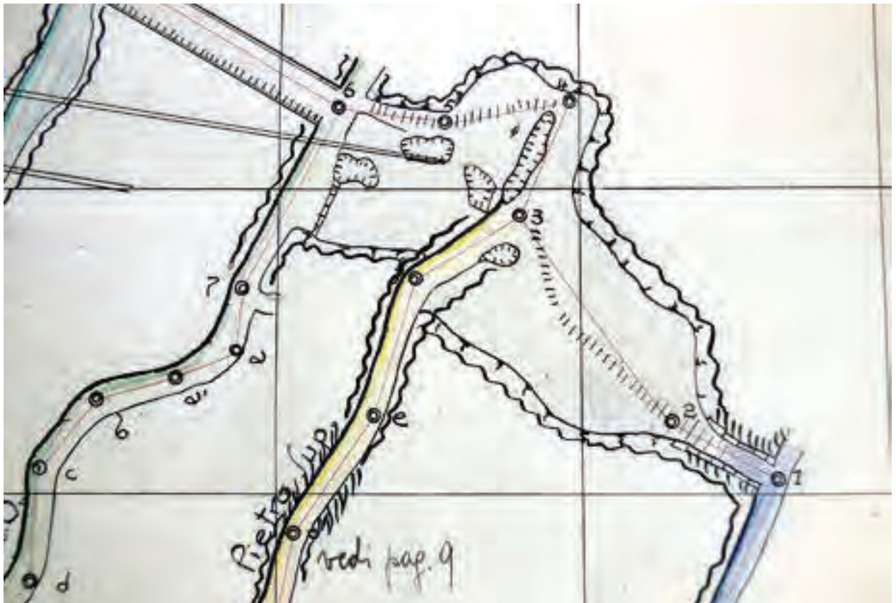
Abbildung 20: Detaillierte Darstellung der Stollen Paul und Peter im Bereich des Schrägschachts A.M.M.I. (Passaggio Paolo – Pietro e disc. A.M.M.I.), in: Miniera di Monteneve, Registro dei rilievi all'interno e all'esterno con Tacheometro 1942, 1943, 1944 (Haupt-Zugbuch), Doppelseite 8 . Schneebergarchiv des Südtiroler Bergbaumuseums, Inv.-Nr. 1095. Die dünne rote Linie deutet die gemessenen Polygonzüge an; die kleinen Kreise bezeichnen die Polygonpunkte, die zumeist in der Firste vermarktet wurden und unter denen das Messinstrument aufgestellt wurde. Gelb dargestellt ist der obere Peter-Stollen.
