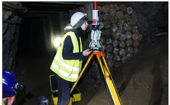
Abb. 2: Kreisvermessung unter Tage mit der Totalstation TS06 und dem Aufsatzkreisel AK-2M: Am Instrument Susan Zimmer, links: Aleksandra Babaryka, M. Sc., Dr.-Ing. Thomas Martienßen
