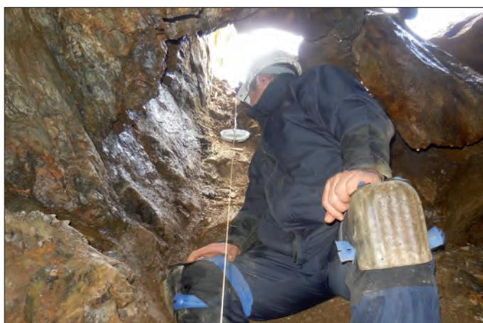
Abb. 2: Vermessung eines untertägigen Grubenbaus mit Hängezeug
