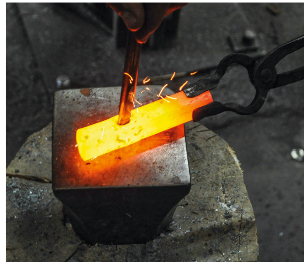
Abb. 10: Aufspalten des Bergeisenrohlings (Holdermann / Trommer 2013).
