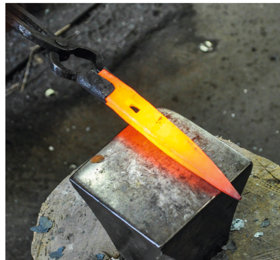
Abb. 11: Ausschmieden der Bergeisen spitze (Holdermann / Trommer 2013).
