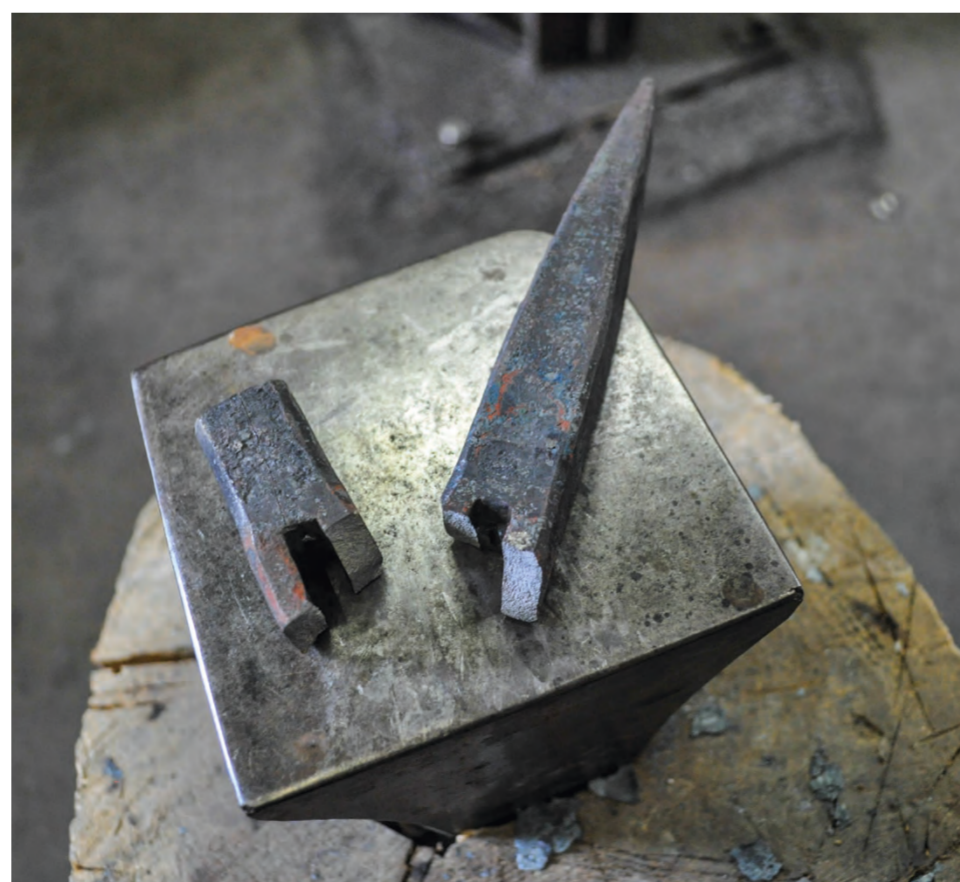
Abb. 14: Durch gezieltes Überhärten herbeigeführter Spannungsriss im Bereich des Hauses des Bergeisens (Holdermann / Trommer 2013).
