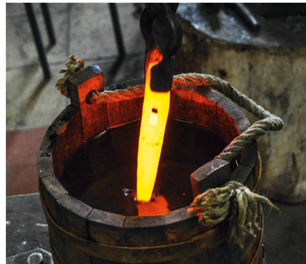
Abb. 12: Härten des Spitzenbereichs im Wasserbad (Holdermann / Trommer 2013).
