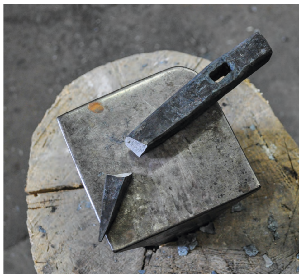
Abb. 13: Durch gezieltes Überhärten herbeigeführter Spannungsriss im Bereich der Bergeisenstange (Holdermann / Trommer 2013).
