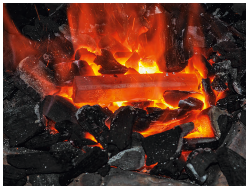
Abb. 9: Abgelängter Bergeisenrohling im Schmiedefeuer (Holzkohle) (Holdermann / Trommer 2013).
