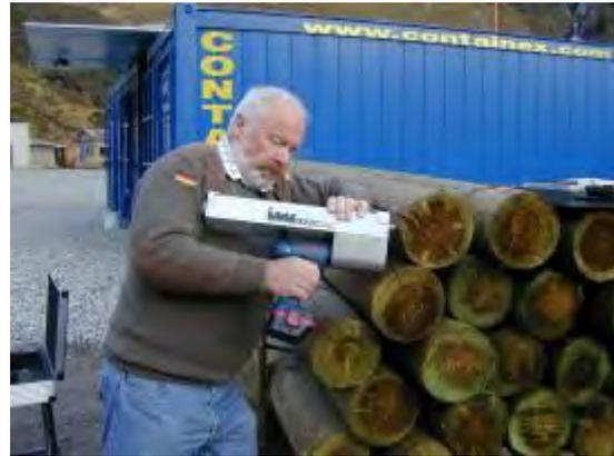
In den ersten Jahren wurden mit jedem Holzeinbau in Kiefer auch einige nicht behandelte Stempel und Kappen aus Lärche und Akazie in den unterschiedlichen Streckenabschnitten eingebaut. Somit konnte in den Jahren auch die unterschiedliche Resistenz der Hölzer unter den gegebenen Bedingungen Untertage gegenüber den Pilzen beobachtet werden.
